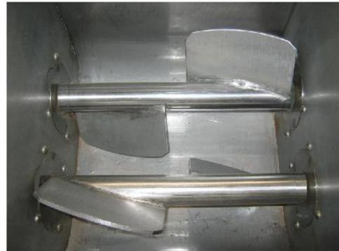
Машина предназначена для замеса теста при производстве хлебобулочных изделий, так же может применяться в кафе, столовых для перемешивания различных соусов и начинок, в кондитерских цехах малой и средней мощности.
